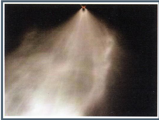
Simulation d'une application herbicide sans HELIOSOL®. Vent latéral de 7,5 Km/h
