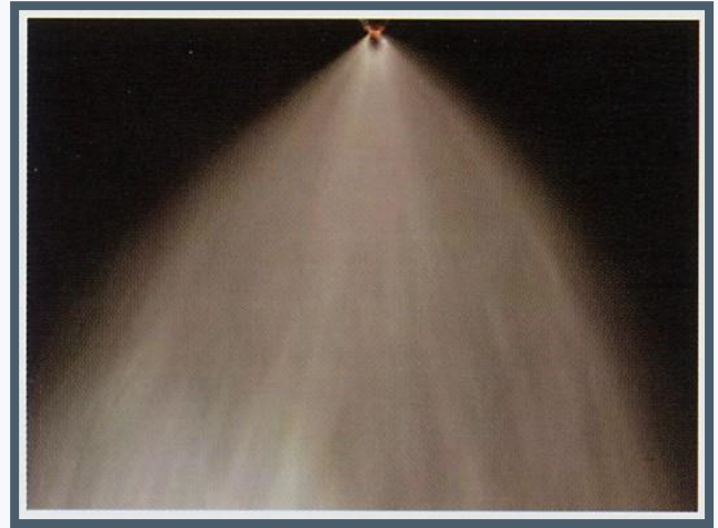
Simulation d'une application avec herbicide avec HELIOSOL®. Vent lateral de 7,5 Km/h
